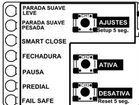
Para ativar as funções, pressione o botão **AJUSTE** até o LED indicativo da função acender, em seguida aperte o botão **ATIVA**. Para desabilitar repita o processo e pressione o botão **DESATIVA**
